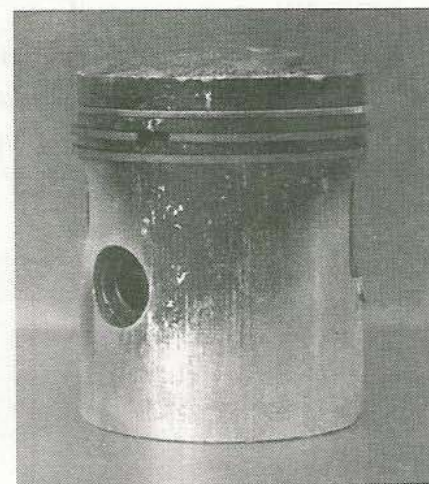
20. ábra: koks- és lakk-képződés a dugattyú felületén
