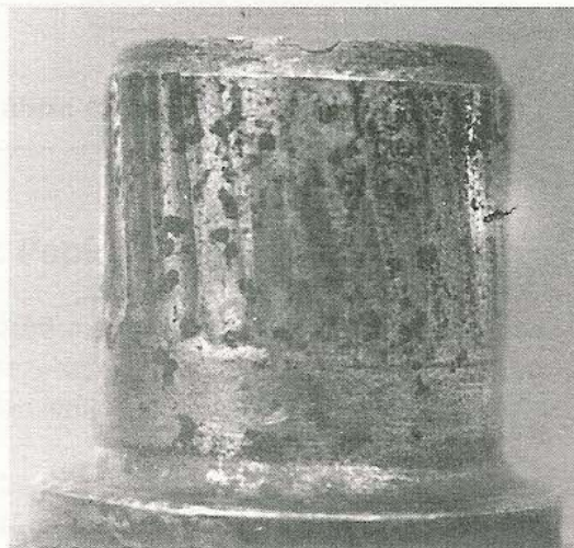
45. ábra: beverődött görgők nyomai a kardánkereszt csapján
