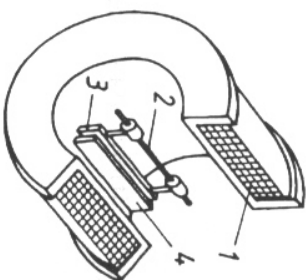
24. ábra. Keretekecrcses műszer szerkezete
