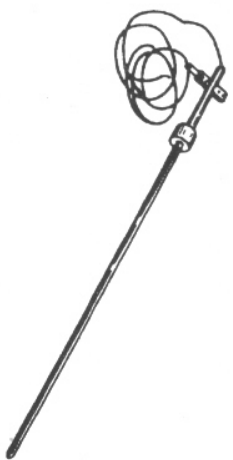
194. ábra. Hőmérséklet-érzékelővel ellátott olajművópálca
