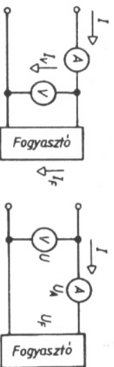
116. ábra. Teljesítménymérés voltmérővel és ampermérővel
