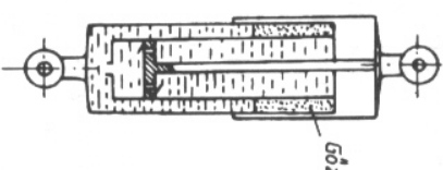
243. ábra. Visszacsapó szelepes, kétsőves lengéscsillapító
